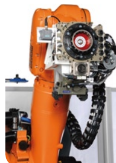
Schnellwechselkupplung am Roboter zur Aufnahme der Greifvorrichtung
