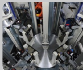
4 Bearbeitungsstationen mit Linearachsen zum Verfahren der Spezialwerkzeuge
