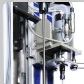
Das Spezialwerkzeug entgratet die Bohrungsverschleißungen in den Tieflochbohrungen
