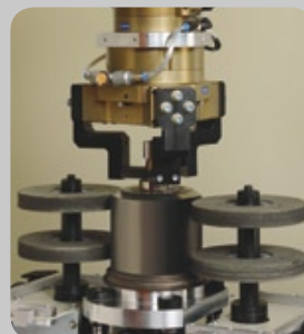
Doppelbürsten mit einstellbarer Rotationsgeschwindigkeit
