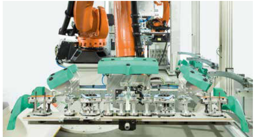
Derivatspezifische Warenträger dienen als Aufspannvorrichtung für die Stoßfänger.
