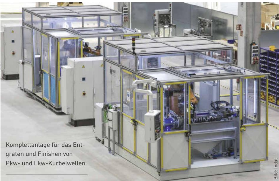
Komplettanlage für das Entgraten und Finishen von Pkw- und Lkw-Kurbelwellen.
